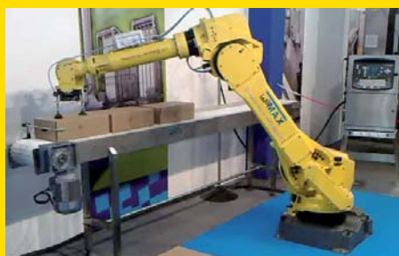
Sistema flexible de minipaletizado de cajas
