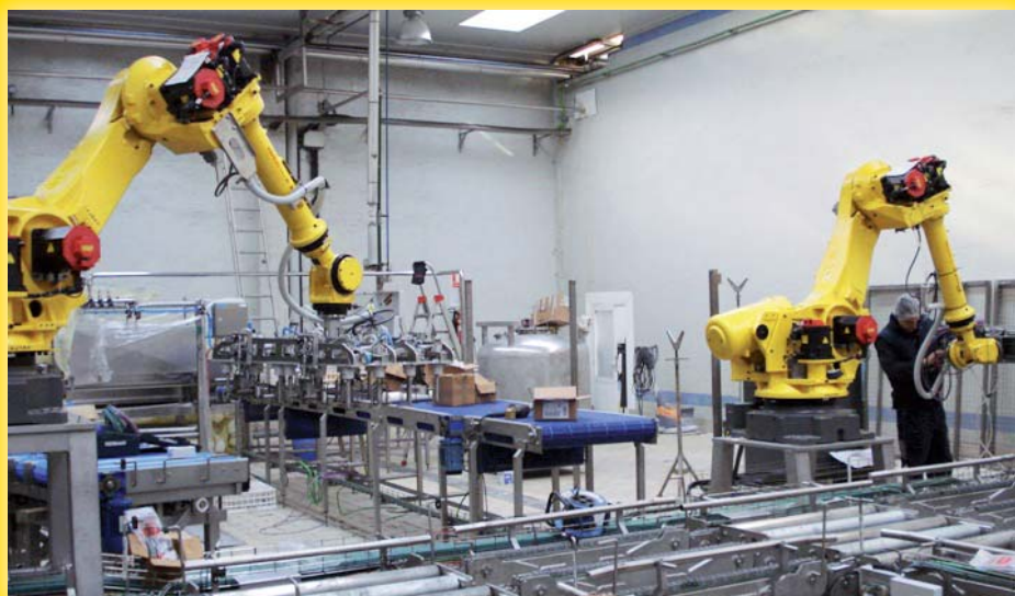
Instalación de despaletizado y paletizado de canastas de quesos
