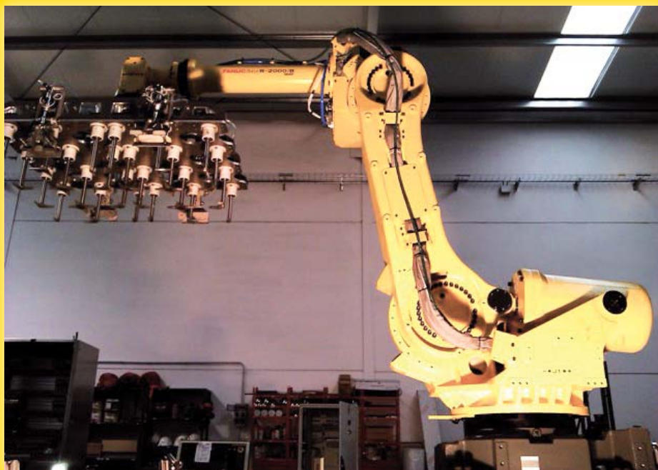
Robot manipulador de quesos para alimentación a sistema de pintado.
