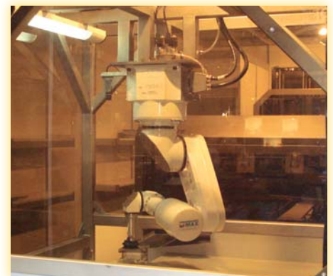
Célula de picking para encajado de bolsitas de bizcochos
