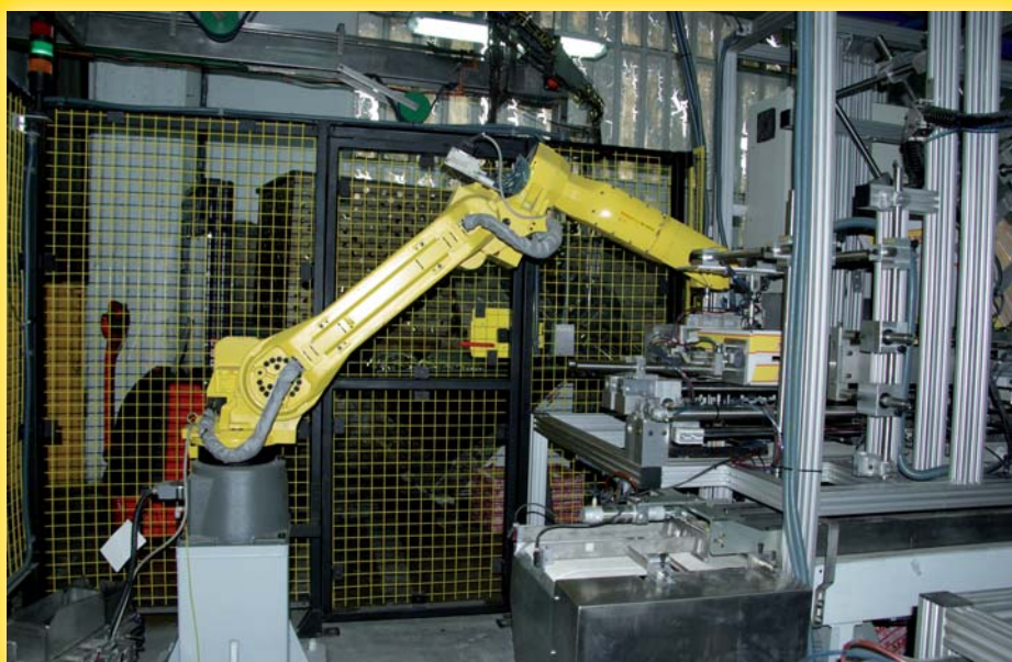
Instalación “Encajadora Multiformato”: robot M-20iA, transportador de salida y dispensador de cajas
